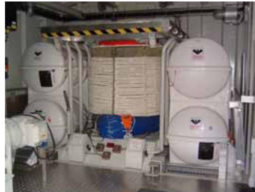
Спасательные плоты являются составной частью спасательной системы и надежно размещены внутри взрывостойкого контейнера
