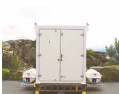
Спасательные плоты системы SES 2B размещены вне контейнера.
