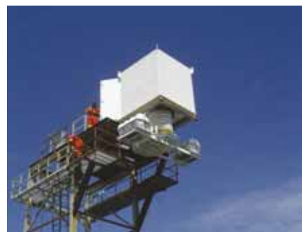
Раскрытие системы. Спасательные плоты спускаются вместе с рукавом.
